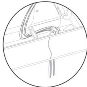
Replacer le joint en mousse sur les fils.
